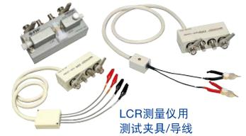
LCR测量仪用测试夹具/导线
