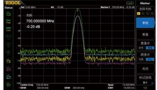
通过“零扫宽”功能解调AM信号,观察调制信号的波形
