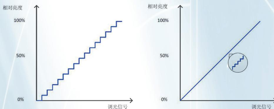
本文案例是一个客户需要快速测量 PWM 调光时的输出电流线性度和平滑度，进而再积分球测试亮度线性度。被测器件是一款集成度极高，具备恒压或恒流输出的双模式 BUCK 和无极性接入的载波二总线芯片。同时客户又担心这种具备总线功能的调光芯片，在总线通讯时会不会对 LED 调光产生影响。而 Buck 部分高达 1Mhz 的开关频率，同时又为电流测量带来了不小的挑战。本文选择使用了 TCP0030A 探头，此探头可以达到 120Mhz 带宽，对于高速电流信号的测量非常合适。
