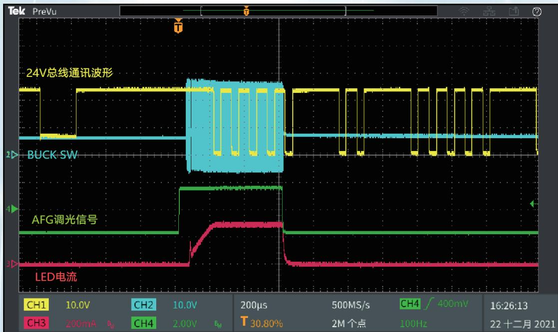
可见，在总线通讯波形快速变化时，灯串电流依然没有任何的毛刺或者上下过冲。
