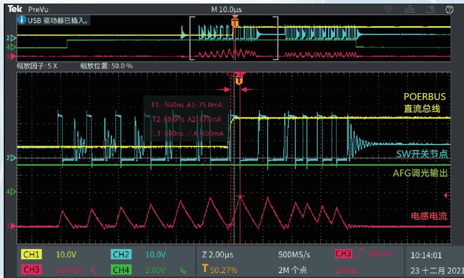
可见电流在开周期时候最高达到约 900mA，得益于 TBS2000 高达 20M 的存储深度，ZOOM 后波形依然非常清晰，可见目前所选电感未出现电流翘尾的饱和现象。当然，想要更仔细的评估电感的可用度，还需要对各种不同开关模式下的电感电流做更多的测试，可见上一篇文章。这个电流的上升时候仅有 640ns！这是一款开关速度 1Mhz 的恒流 LED 驱动芯片，低速电流探头是无法测量的，对于这种信号的测量，这款 TCP0030A 高达 120Mhz 速度的电流探头，几乎是唯一选择。
