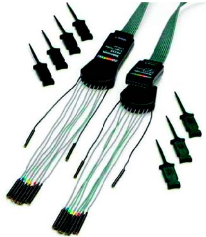
P6316 MSO 探头提供了两个 8 通道适配夹，简化了与设备的连接。
