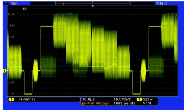
查看 NTSC 视频信号，注意 DPO 提供的辉度等级视图，其能够表示时间、幅度和幅度分布随时间变化。
