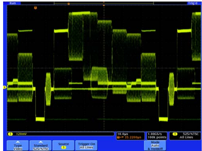
查看 NTSC 视频信号，注意 DPO 提供的辉度等级视图，其能够表示时间、幅度和幅度分布随时间变化。
