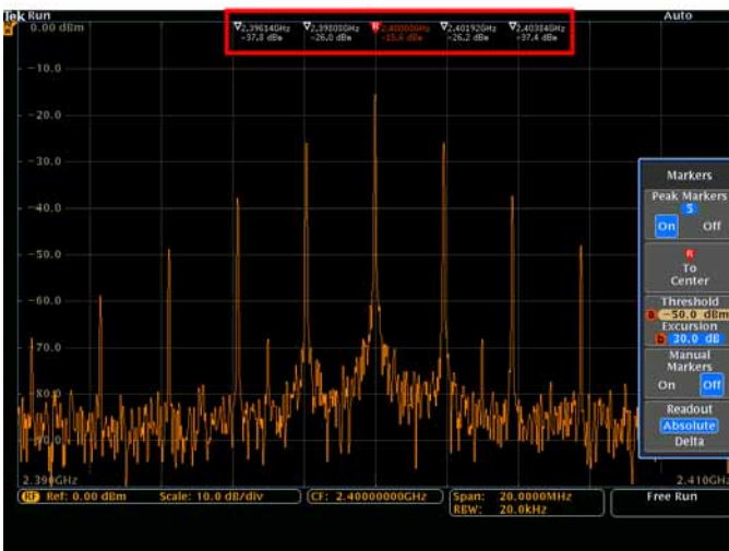
自动峰值标记一目了然地识别关键信息。如本图所示，满足门限和突出标配的 5 个最高幅度峰值被自动标出。
