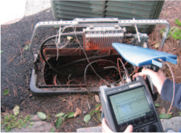
图 1a. FieldFox 连接到定向天线，用于定位无线干扰源
