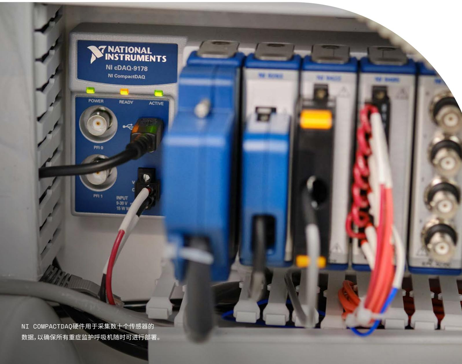
NI COMPACTDAQ硬件用于采集数十个传感器的数据,以确保所有重症监护呼吸机随时可进行部署。
