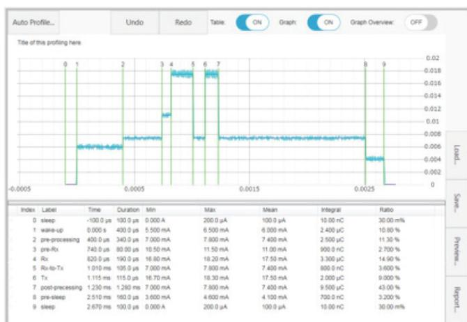
图 12. 使用 CX3300 上的自动电流和功率分析工具分析电流消耗
