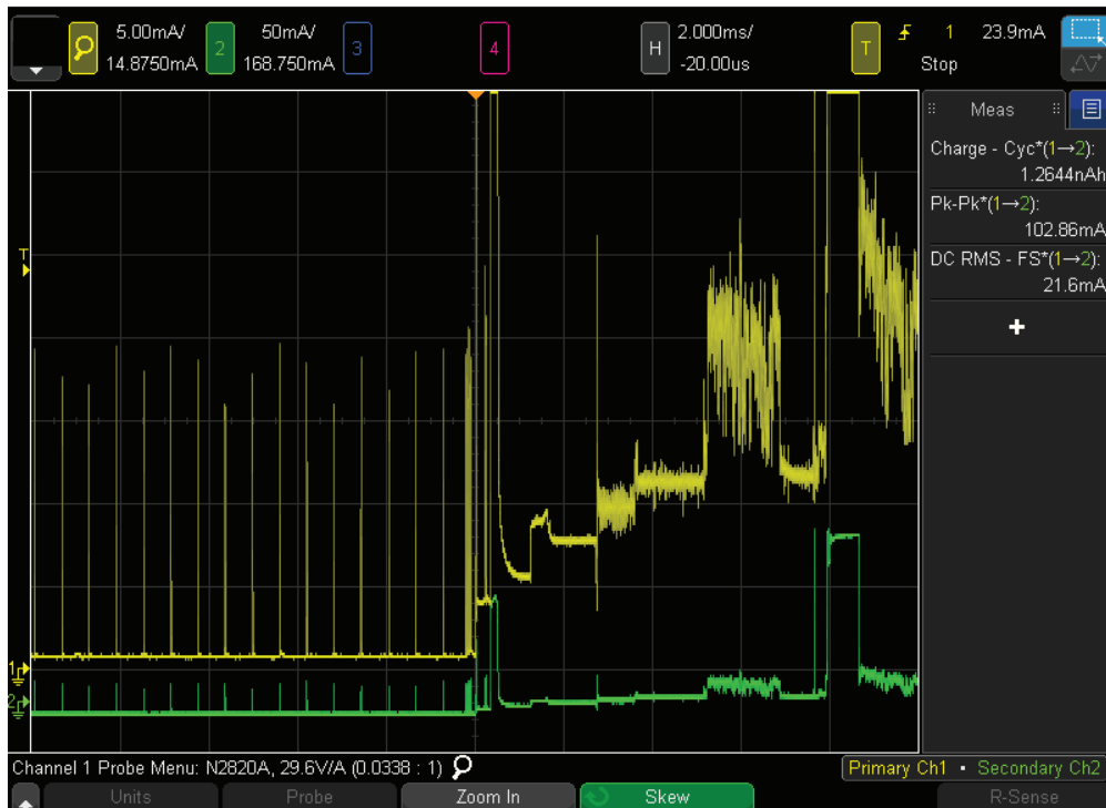
图 5. InfiniiVision 3000 或 4000 X 系列示波器和 N2820A 电流探头为 50 \mu A 至 5A 宽动态范围的测量同时提供低增益和高增益视图。
