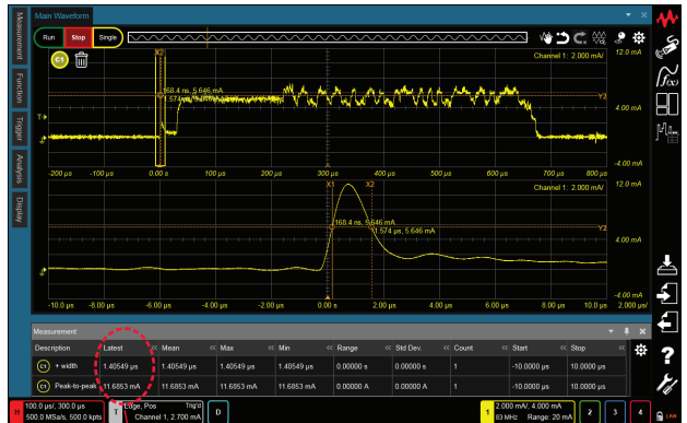
圖 16：搭配電流波形同步進行電壓量測以進行有效的設計驗證
