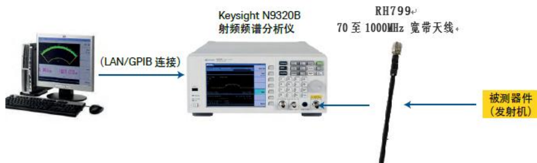
图 1.测量 ASK/FSK 发射机的典型系统设置
