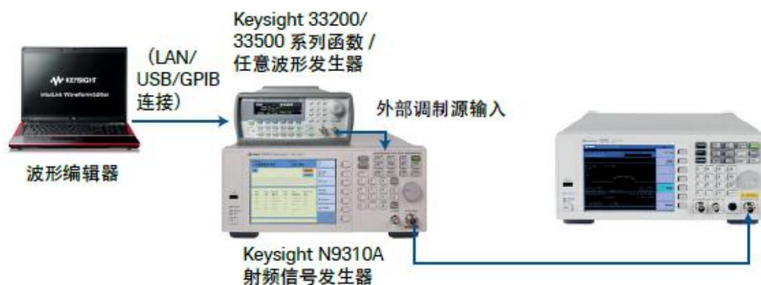
图 3.FSK 信号生成和测量的设备配置
